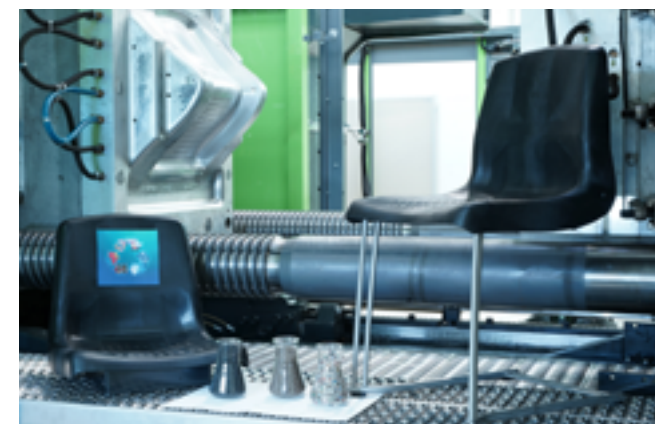
Aus kunststoffhaltigem Abfall wurde im Projekt Polyamid extrahiert, das im Spitzguss zu einer Stuhlschale verarbeitet wurde.
