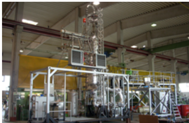
Pyrolyseanlage zur Verölung von kohlenstoffhaltigen Abfällen.
