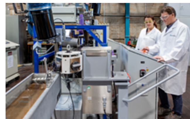
Eine Methode zur Online-Rheologie als schnelles Diagnose-Tool zur Rezepturentwicklung wurde im Projekt entwickelt.
