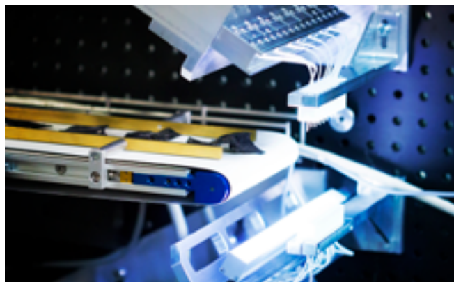
Ein im Projekt entwickeltes Sensorsystem erkennt und klassifiziert Kunststoffe präzise – selbst schwarzen, rußhaltigen Kunststoff.
